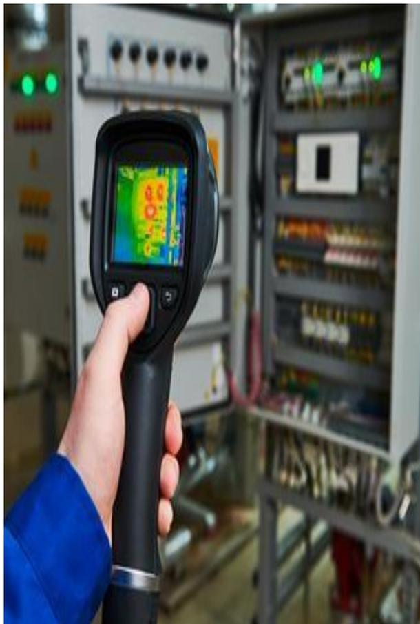
**El Estudio Termográfico Predictivo permite cumplir con la ordenanza del Cuerpo de Bomberos para obtener el permiso de funcionamiento ANUAL, donde se diagnostica si existen puntos y focos calientes de alto riesgo, proponiendo los correctivos necesarios**
